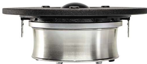
Magnes neodymowy to cienki plaster, dość blisko frontu głośnika; metalowa część poniżej jest wyfrezowaną w aluminium komora wytłumiająca.
